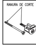
Mida el ancho de su puerta y Corte el largo de la lengüeta del cilindro y de los tornillos en la marca de corte según lo requiera.
