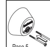
Antes de colocar verifique que se ensambló correctamente. Una vez centrado coloque los tornillos en los alojamientos de la unidad interior, y atornille. Verifique el funcionamiento. Apriete y ajuste la cerradura.
